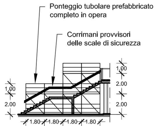
**Ponteggio di sicurezza e di servizio su Scale di sicurezza in c.a.**
