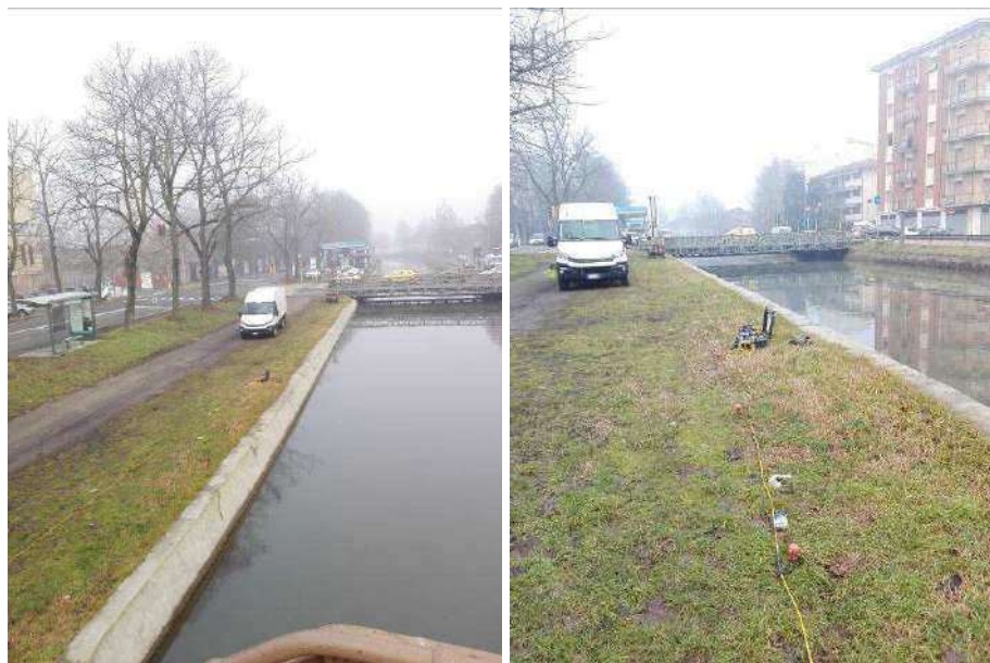
Esecuzione della prova sismica MASW.
