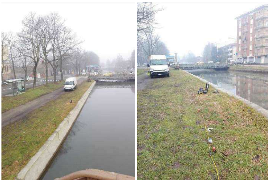
Esecuzione della prova sismica MASW.
