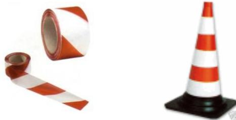
Queste recinzioni vanno utilizzate per delimitare aree di scavo con profondità inferiore a 1,50 metri e con longitudinalità molto estesa come, ad esempio, percorsi cavi, percorsi linee interrato, etc.
