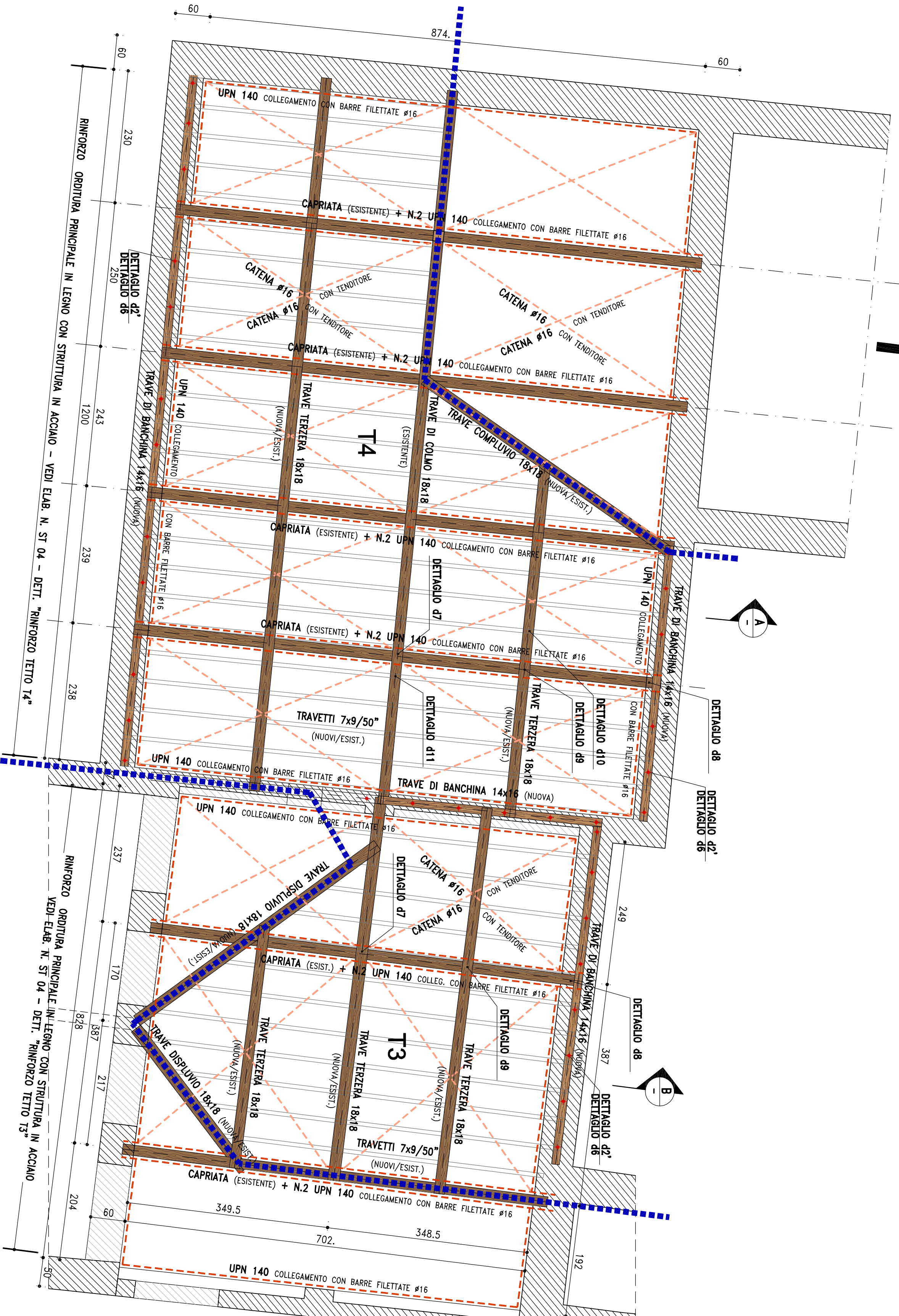
SCHEMA IN PIANTA - ORDITURA TETTO
