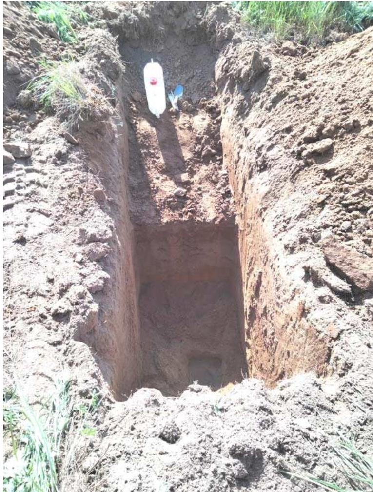
**Fig.5:** Particolare della trincea Tr1 sul cui fondo è stata effettuata la prova di permeabilità
