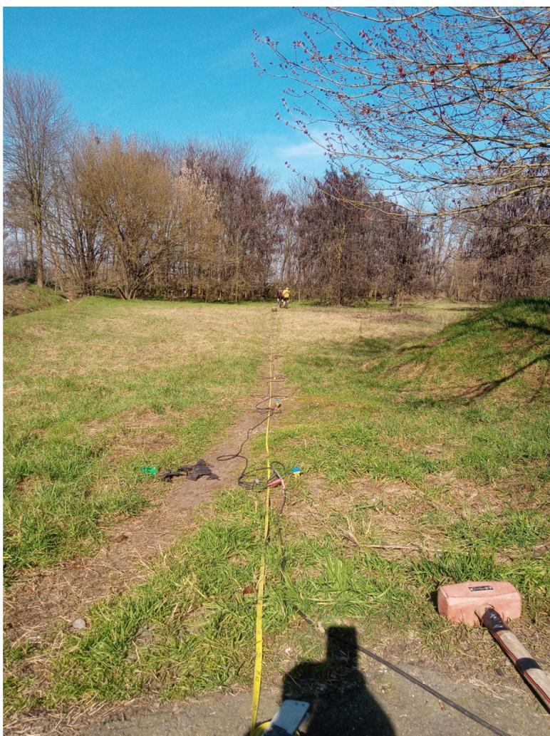
**Fig. 12** – Stendimento sismico
