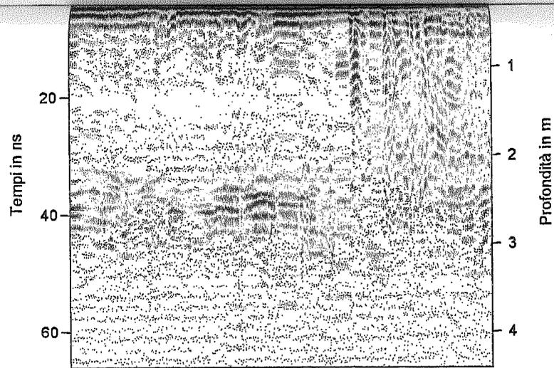
Sezione georadar pv21
