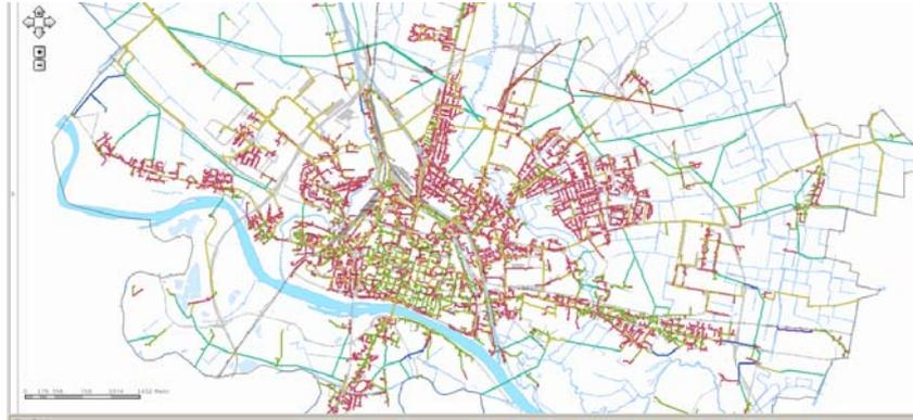
**Figura a5.39 - Terminazioni orientali della rete di fibra ottica, con tipica struttura ad antenna, ed anelli parziali.**
