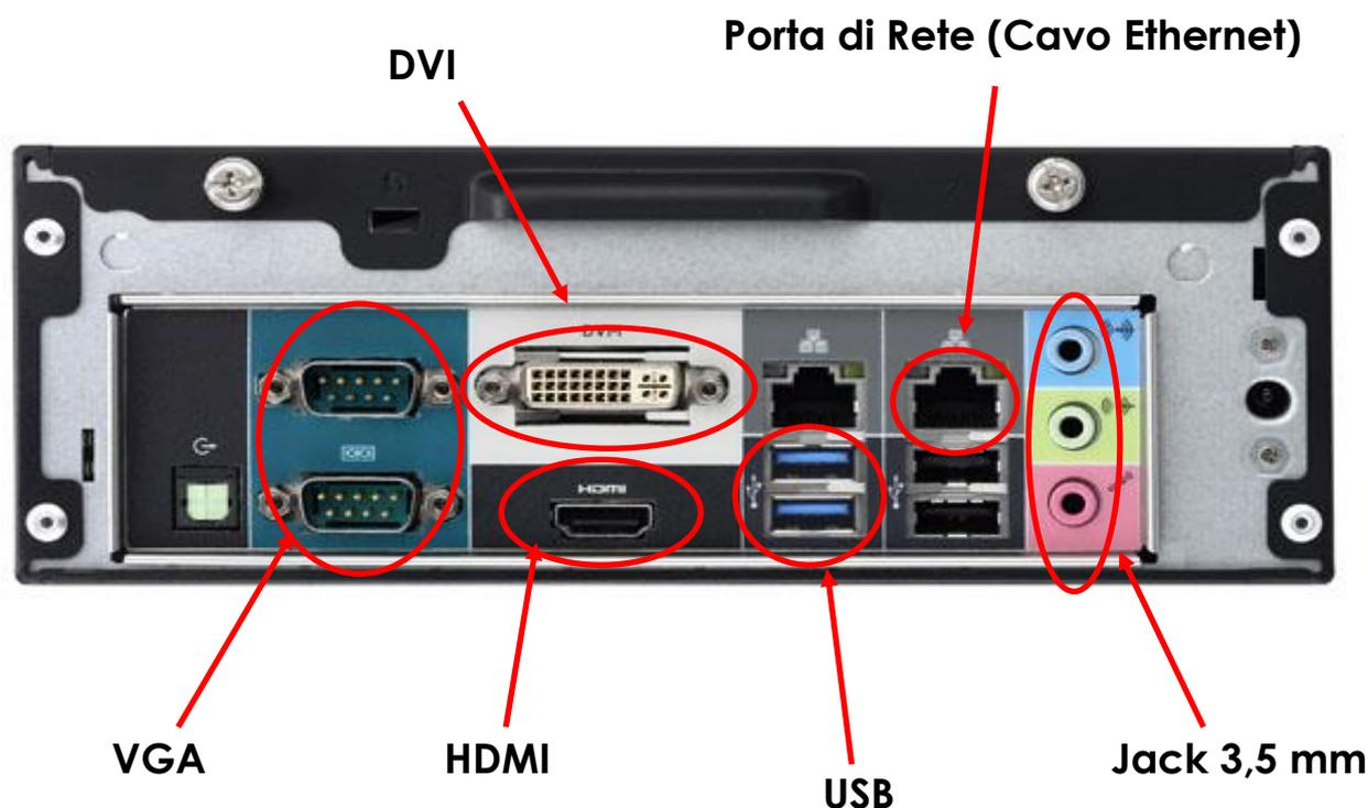
DVI, VGA e HDMI sono porte video da collegare al monitor tramite gli appositi cavi.
